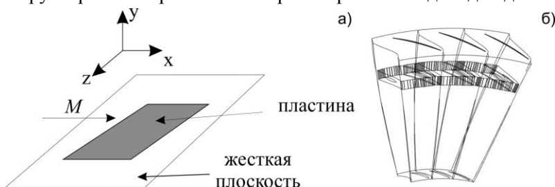
Рис. Геометрия задачи: а) одномодовый флаттер пластины, б) флаттер лопатки
