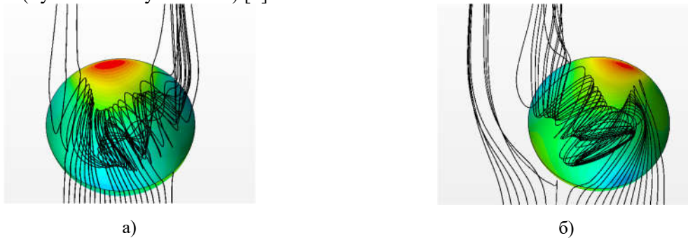
Рис. Структура потока в окрестности лунки при Re_D = 40\,000 . а) Осреднения по 3м циклам переключения, б) Осреднения в рамках одного режима.
