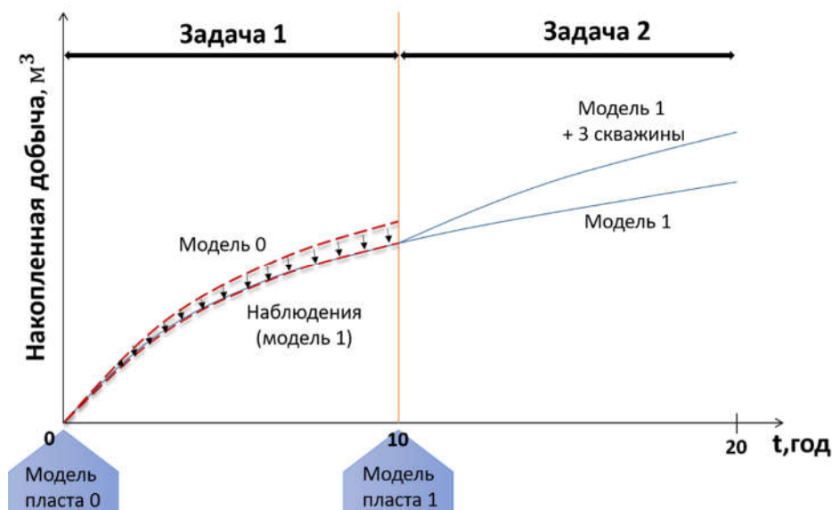
Рис. Иллюстрация постановки задач 1) – корректировки модели 0 к наблюдениям и 2) - оптимальная расстановка нагнетающих скважин для увеличения добычи нефти.
