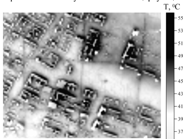
Рис. Тепловая карта города. Данные получены при помощи ИК камеры FLIR SC5000 после длительного нагревания поверхности города инфракрасным нагревателем.
