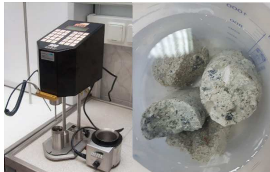
Рис. 1. Фото вискозиметра (слева), и фото образца горной породы помещенного в буровой раствор (справа)
