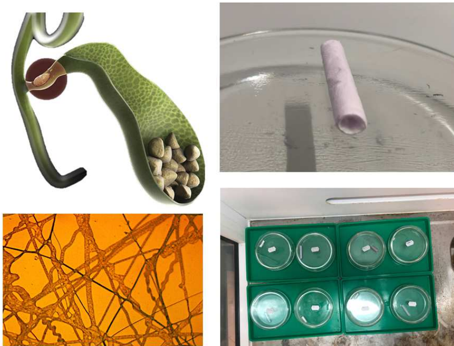
Рис. Исследование и создание образца желчного протока: верхний слева рисунок – геометрия желчных протоков и желчного пузыря с камнями; верхний справа рисунок – образец протока, изготовленный с помощью электроформования; нижний слева рисунок – структура волокон, полученная путем микроскопии; нижний справа рисунок – набор образцов в чашках Петри.
